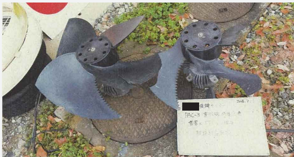
〈写真〉破損したプロペラファン
